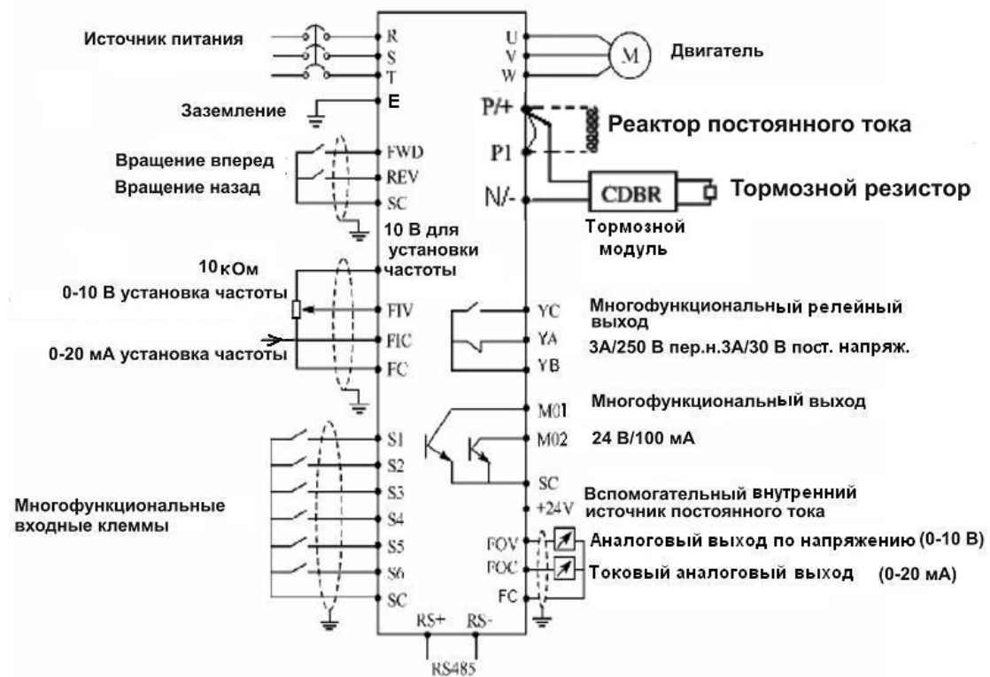
4-2-2 Расположение управляющих клемм (0,4~450кВт)
